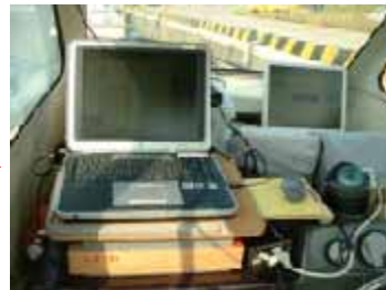
GPSデータと測深データがシステム連動
