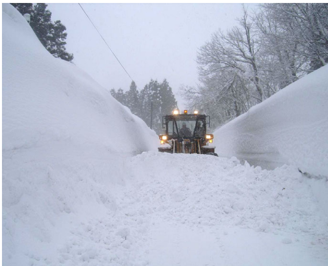
タイヤドーザによる除雪
