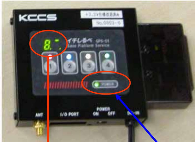
電源コード(シガライター用)をシガソケットに常に挿入しておけば、エンジン始動時に自動的に起動し送信を開始します。
